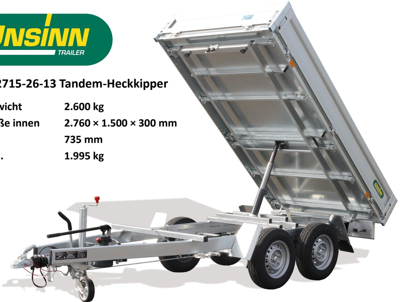
Rahmen komplett im Tauchbad verzinkt, Bordwände ALU-Hohlprofil, eloxiert, vierseitig abnehmbar, versenkte Verschlüsse, Stahlboden, hydraulische Kippeinrichtung, verstärktes automatisches Stützrad
